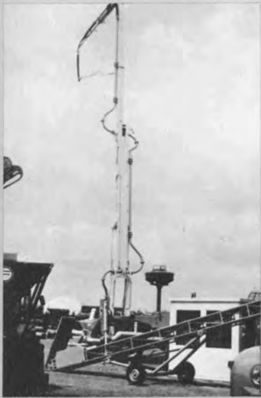
▲コンクリートポンプ車のマスト
