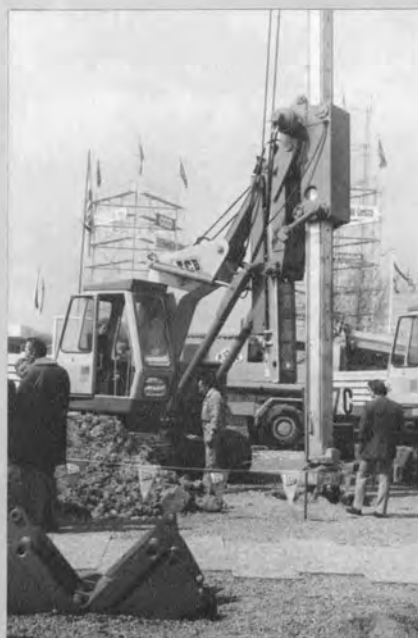
▲油圧式掘削機のアタッチメント (ノーケーシング立孔掘削機)
