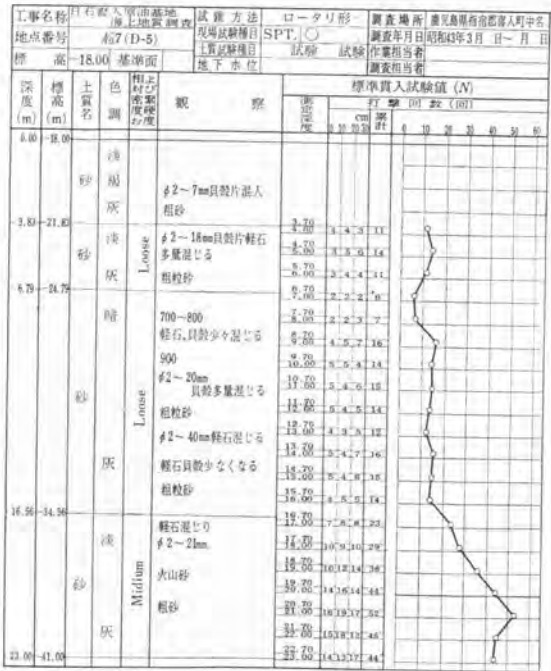
図-5 主ドルフィン(D-5)土質柱状断面図
