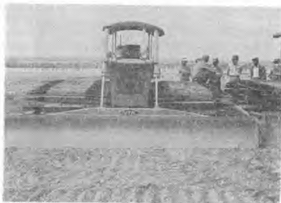
写真-13 超々湿地ブルドーザ(接地圧 0.125 \text{ kg/cm}^2 )
