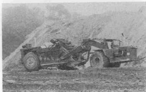
写真—3 ワブコ BT 333 F エレベータリングスクレーパ
