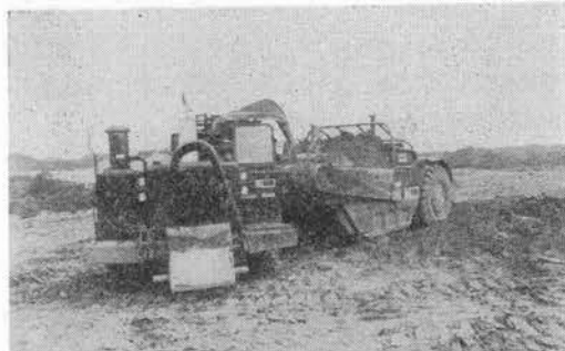
写真—2 Cat 657 ツインエンジンスクレーパ (前部はプッシュプル用装置)
