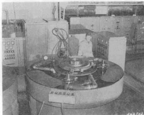
高周波焼入装置の一部
