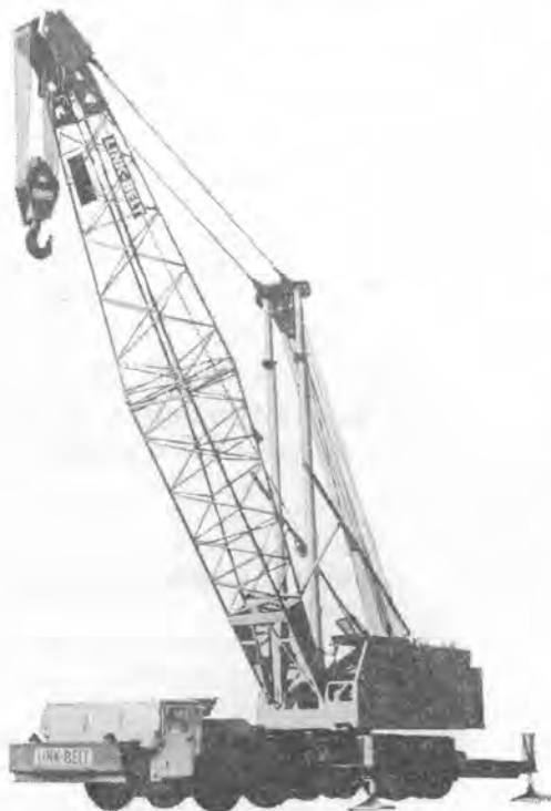
写真-2 機械式トラッククレーン “HC 238 J”
