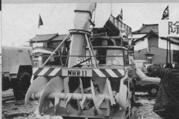
▲スノーローダ NHR-11 (100 PS・ロータリ式1車線・新潟鉄工所)
