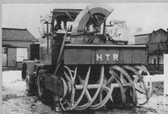
▲ロータリ除雪車 HTR 41 (200 PS・日本除雪機製作所)
