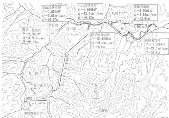
図-2 豊平峡および砥山水路平面図
