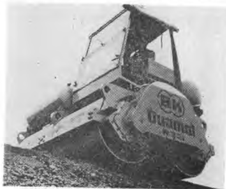
写真-13 自走式の大形 Duomat ダブル振動ローラ
