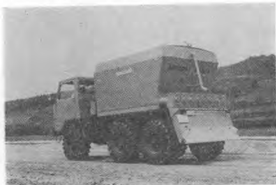
写真-3 3軸シャシに搭載された骨材散布機↑
