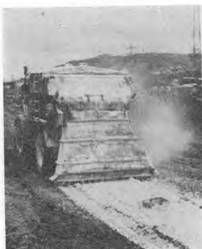
写真-1 ウニモグに搭載された骨材散布機 (Hoes 製)
