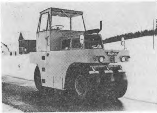
写真-14 全輪操向, トレッド可変のタイヤローラ
