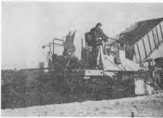
写真-5 コンクリートおよびアスファルトの両舗装工事に用いられる大形フィニッシャ
