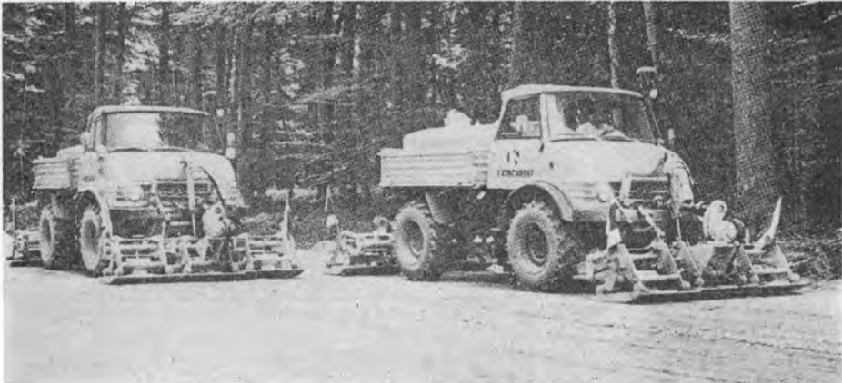
写真-16 ユニモグの前後に取付けた振動プレート (PTO 駆動でアウトバーンの霜よけ砂利施工において)
