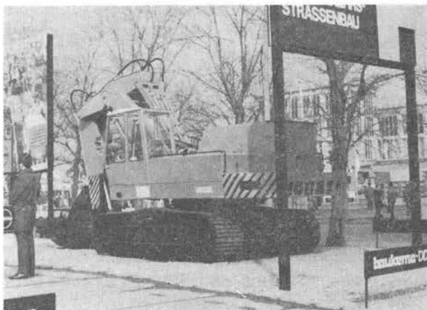
写真—18 NOBAS UB 1231 1.0 m 3 油圧ショベル (ローダバケット付)
