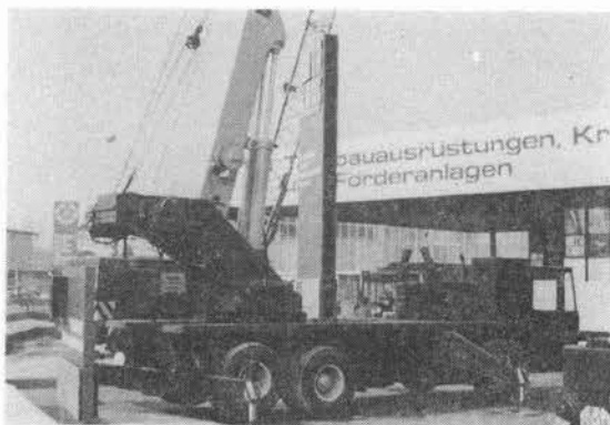
写真-20 TAKRAF ADK 200 T 油圧トラック クレーン (20tぶり)
