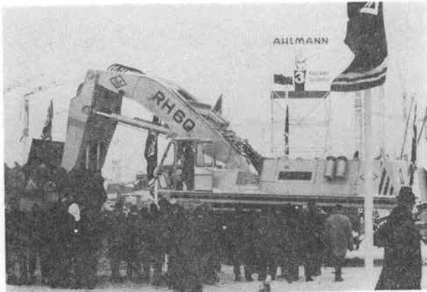
写真-8 O & K RH 60 油圧ショベル (6.5m 3 ローダバケット付)
