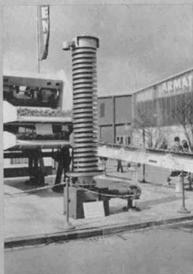
▲振動による粒体の垂直コンベヤ (ハノーバー)
