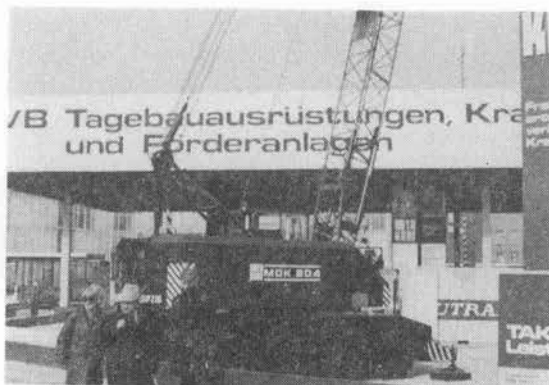
写真-21 TAKRAF MDK 204 ラチスブーム付 トラッククレーン (20tぶり)
