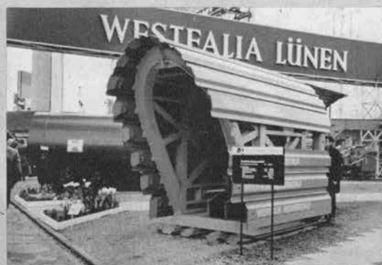
◀機械化されたメッセルシールド掘削機 (ハノーバー)
