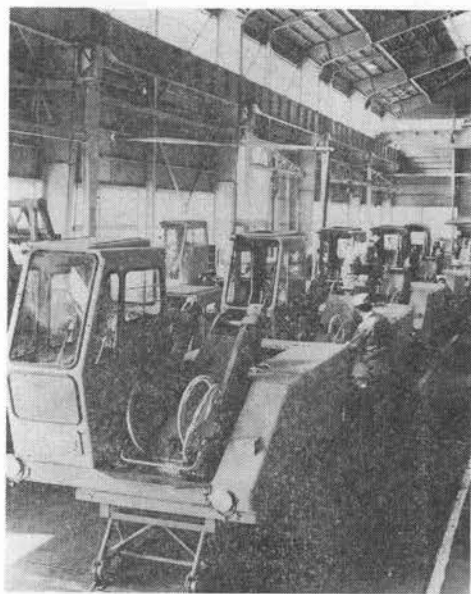
トラッククレーン組立ライン
