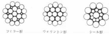
図-34 線接触ロープのストランド構造
