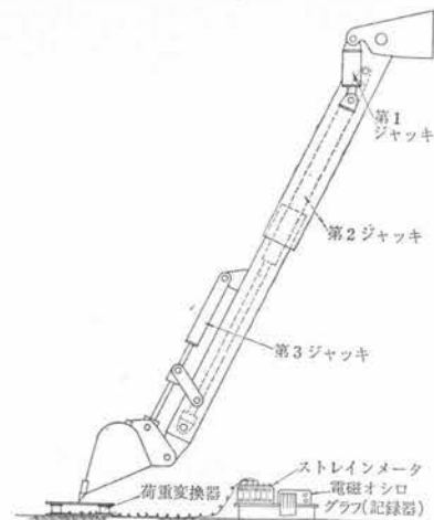
図-2 掘削装置の掘削力試験要領図
