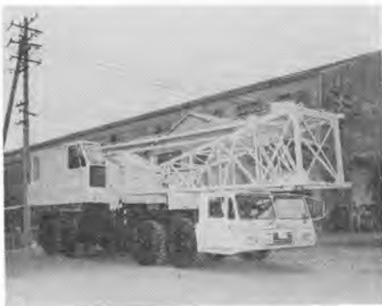
F 500・130 t トラッククレーン
