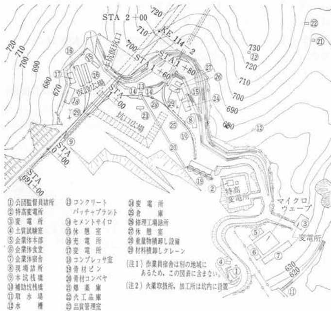
図-2 中津川方(西口)仮設計画一般平面図
