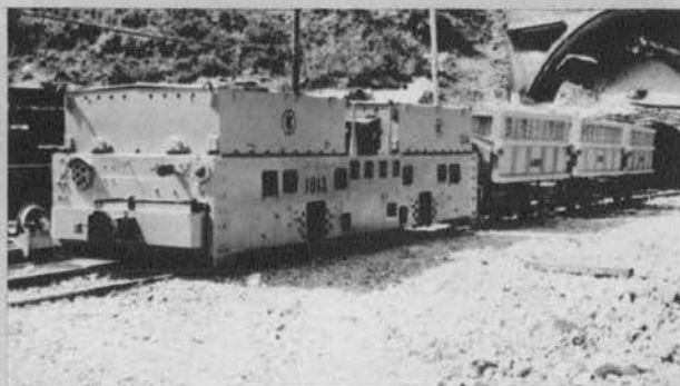
▲蓄電池機関車10 tと4.5m 3 側開きトロ —帆坂トンネル—
