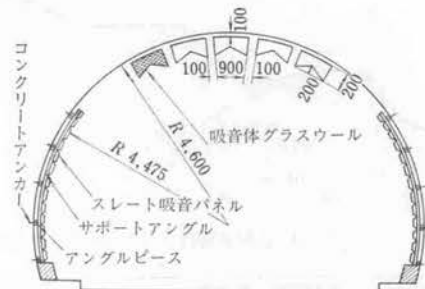
図-10 吸音処理施工断面図
