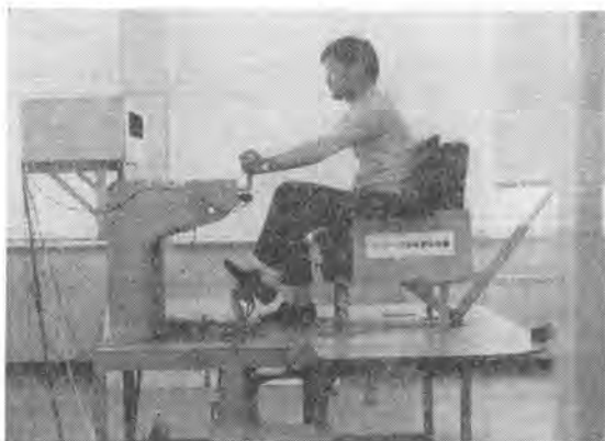
ブルドーザ模擬運転装置によるレバーペダルの最適操作力測定
