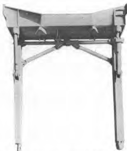
写真-9 ストレートドーザのスライディングセンターボール
