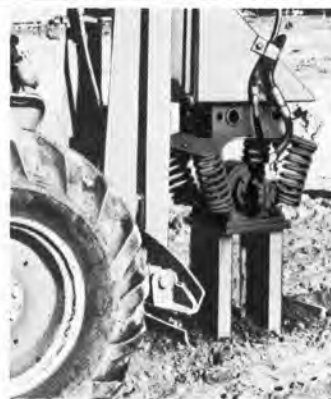
●の狭い溝のつき固めができます。使用現場。ハイバック本体より巾の溝用アタッチメントをつけての
