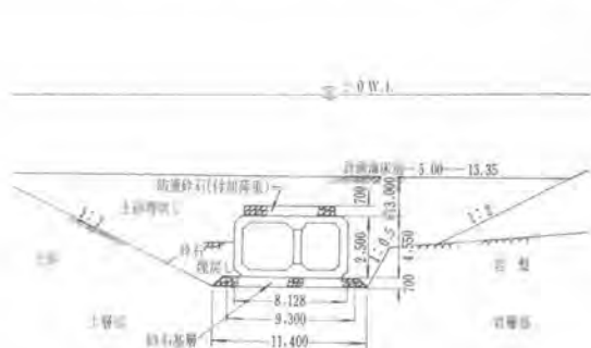
図-4 沈埋トンネル設置標準断面図
