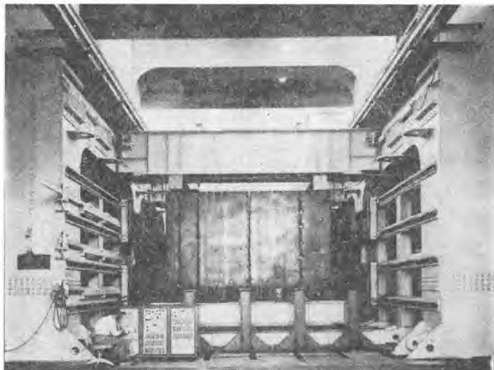
写真-3 波浪荷重試験装置
