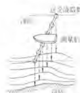
図-2 掃海測深機原理図
