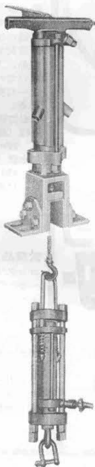
■ シートパイルドライバー
