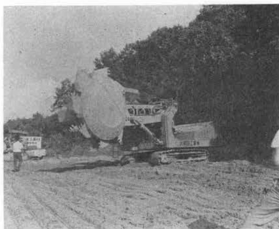
写真-4 バケットホイール掘削機
