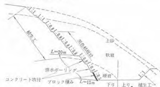
図-7 切取りのり面施工箇所 (STA 148+40)
