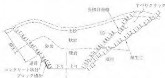
図-6 切取りのり面施工箇所 (STA 150+40)
