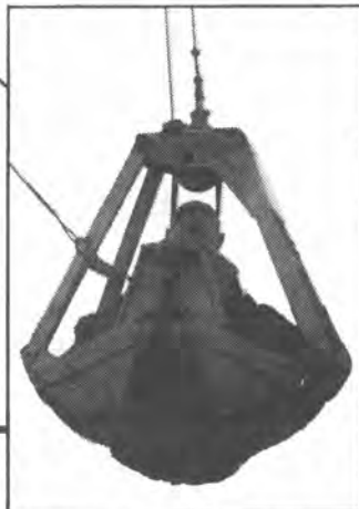
建設現場にて活躍するクラムシェルバケット
