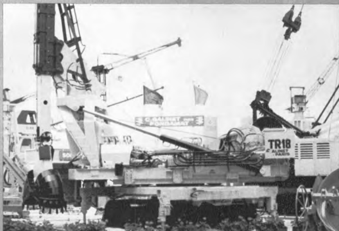
▲地中壁掘削機 (ギャリネットTR18)
