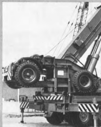
▲トラッククレーン (デマーズ社)
