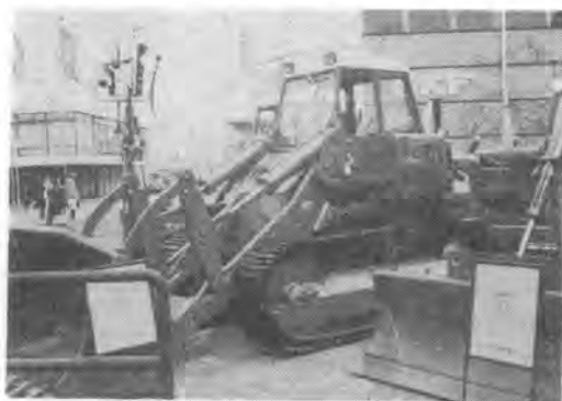
写真-2 Dentz社のリヤエンジントラクタショベル 前方視界がよいことを宣伝していた
