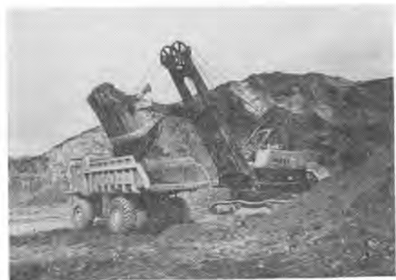
写真-1 ビサイラス 88B パワーショベルおよび CAT 773 ダンプトラック
