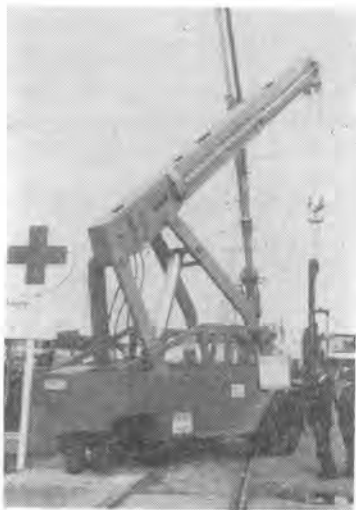
写真-9 Ormig 社のモバイルクレーン 旋回機構をもたず、四つ棒リンクによりつり上げるため巻上げウィンチもない
