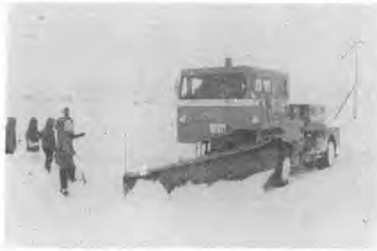
写真-17 除雪トラック (高出力形)
