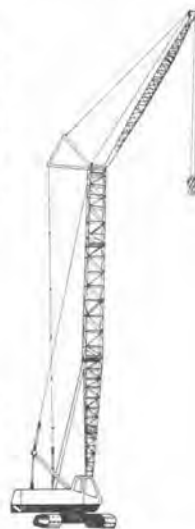
図-58 タワークレーン
