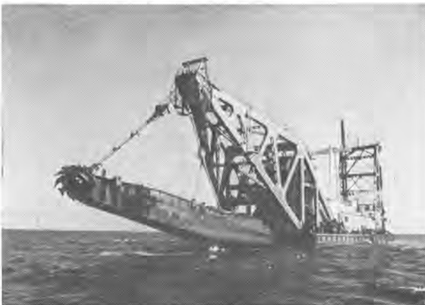
写真-1 D.E. 8,000 PS ポンプ船“駿河”
