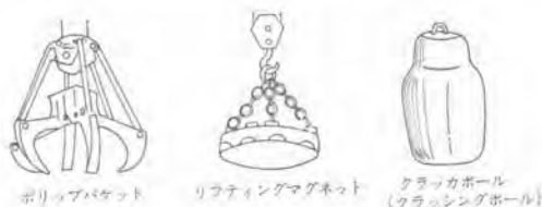
図-57 クレーンアタッチメントの応用例
