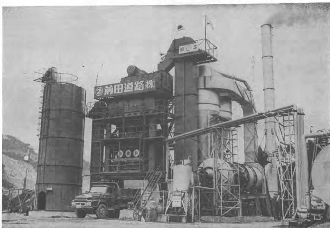
型式NAP-1202AZVW ミキサー2,000kg 能力150T/H
