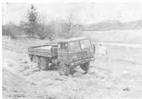
写真-1 6輪220馬力全軸駆動トラック (AB SAAB-SCANIA製) の不整地通過テスト
