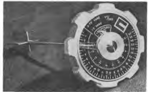
写真-1 ベーン試験機
