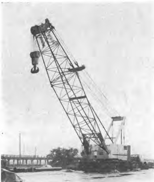
写真-1 機械式トラッククレーン “6250-TC”
