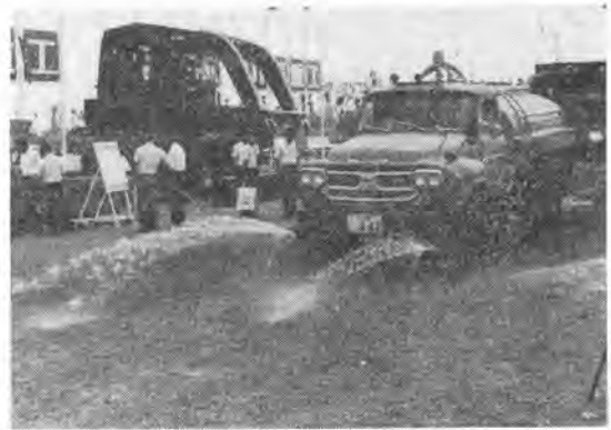
散水車による通路の整備
