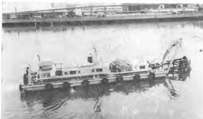
写真-2 60 m 3 /hr ヘドロ採取装置
