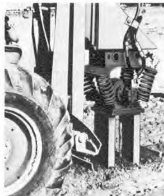
●の狭い溝のつき固めができます。使用現場。ハイバック本体より巾狭溝用アタッチメントをつけての
