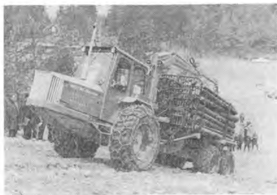
写真-2 6輪61馬力全軸駆動運材車 (Ford Motor Co/Börjes Mek Verkstad) の登坂テスト
