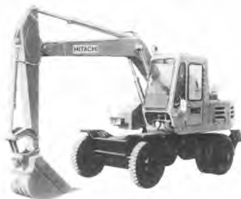
写真-1 車輪式油圧バックホウ“WH 03”
