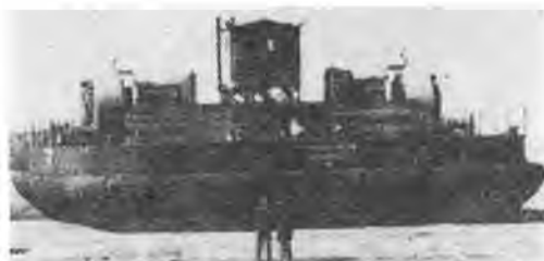
軟弱地を重量物を乗せてすべっていく エアクッション運搬機
