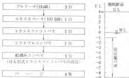
図-6 施工系統図
