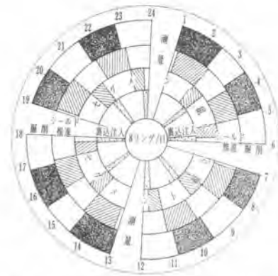
図—11 作業サイクル図(3号および4号機)
