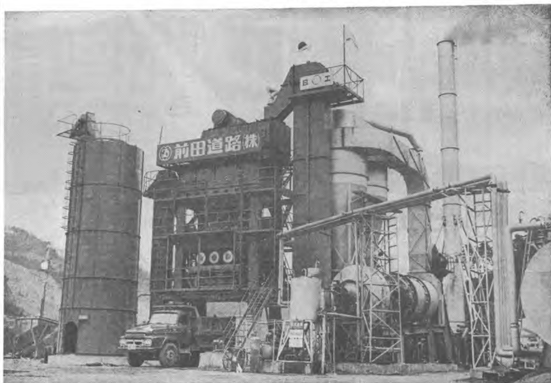
型式 NAP-1202AZVW ミキサー 2,000kg 能力 150T/H
