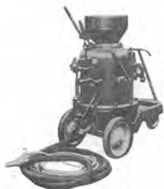
写真-2 トルクレット S3-II 形吹付機
