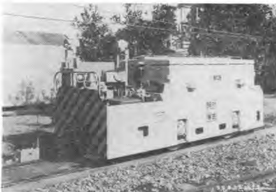
写真-1 わが国初の無線操縦式 6 t 蓄電池機関車
