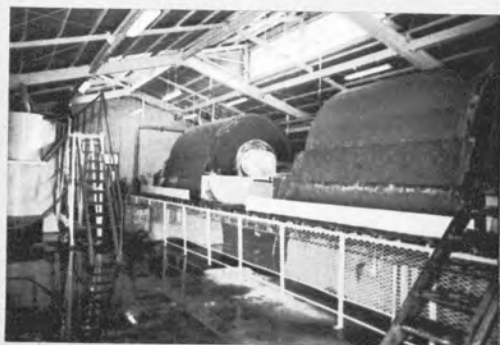
▼トンネル廃水処理場 本州側 処理能力1,200m 3 /hr
