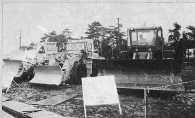
▲除雪ドーザ (180 III アングリングブラウ) 除雪幅 3.45m
