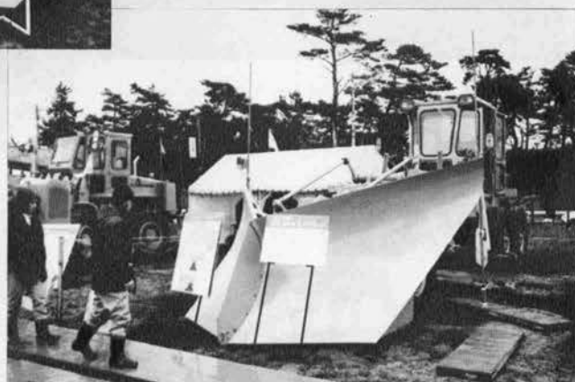
▼ 除雪グレーダ (LG3-H形) 除雪幅 2.6m
