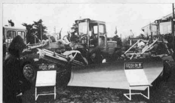
◀ 除雪グレーダ (左) GD37-6 H形 除雪幅 3.7m (右) GD31-3 H形 除雪幅 3.1m
