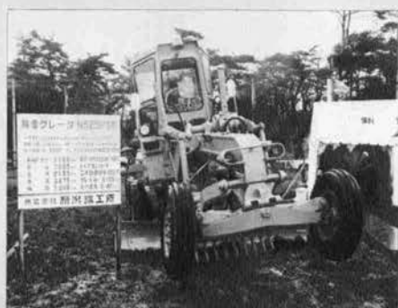
▲ 除雪グレーダ (N525PS形) ブレード長さ 3.1m
