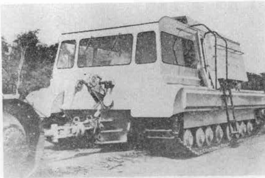
写真-3 重量 65 t の制動車 (MEXE) けん引試験用制動車としては車輪式 (全重量 29 t) 1 台、クローラ式 (65 t, 38 t および連続けん引 専用) 3 台がある。
