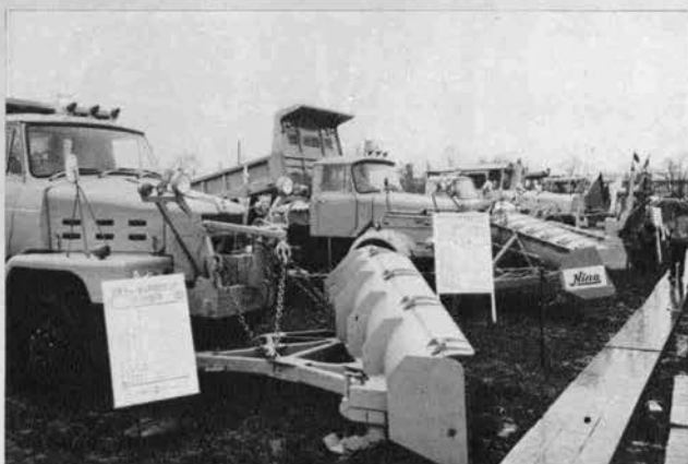
▲除雪トラック (手前) TF 30GD 形 除雪幅 2.85m (後方) ZH100 D 形 除雪幅 2.85m
