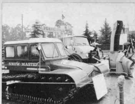
雪上車 (スノーマスタ ST-4 B 7 形) ▶ 最高速度 25km/hr 定員 7 名
