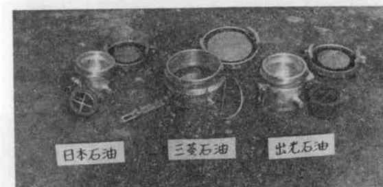
写真-4 C形(ワンタッチ式)給油口(日本石油、三菱石油、出光石油)
