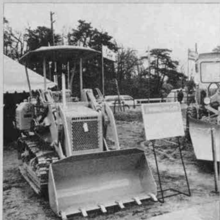
▲トラクタショベル (BS 3 D形) バケット容量 0.4m 3
