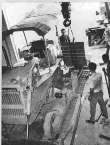
▼工場内でのスプロケット肉盛溶接作業
