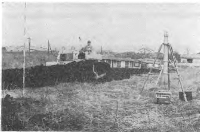
写真-4 日特 LM 形レベリング自動均平装置付湿地ブルドーザ
