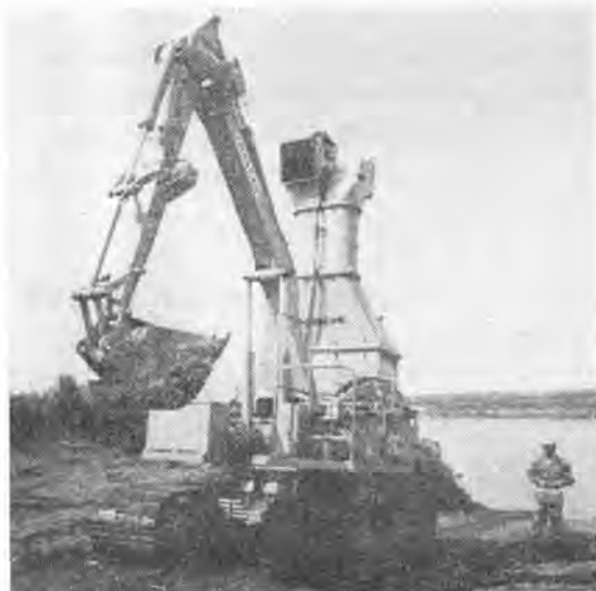
写真—5 日立 UA 03 水陸両用油圧ショベル (無線遠隔操縦油圧式半自動掘削装置付)
