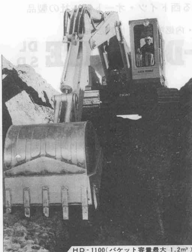
HD-1100(バケット容量最大 1.2m³)
