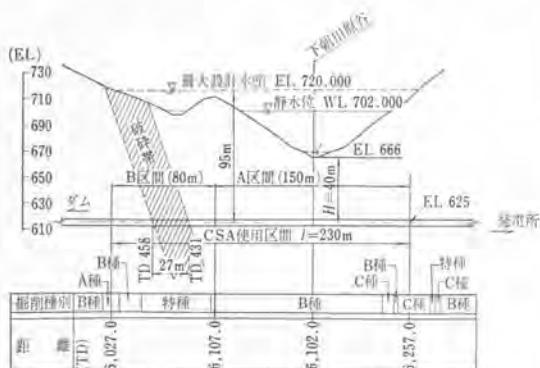
図-8 導水路トンネル下朝川原谷横断部付近縦断図 (CSA 使用区間)
