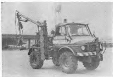
写真-3 せん定機(ウニモグにアタッチメントを付けたところ)
