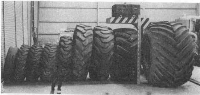
写真-1 供試タイヤ (左から 10.00-20 平滑, 10.00-20 FG, 13.5-20, 18-20, 14.00-24, 18.00-25, 23.5-25, 64×31-25, 66×43.00-25)
