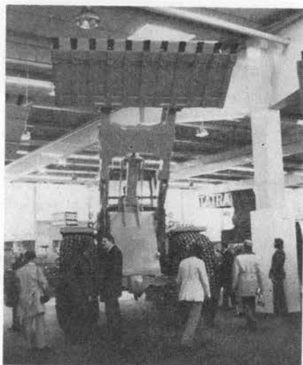
写真—4 ホイールショベルロードダのタイヤにチェーンを取付けたもの
