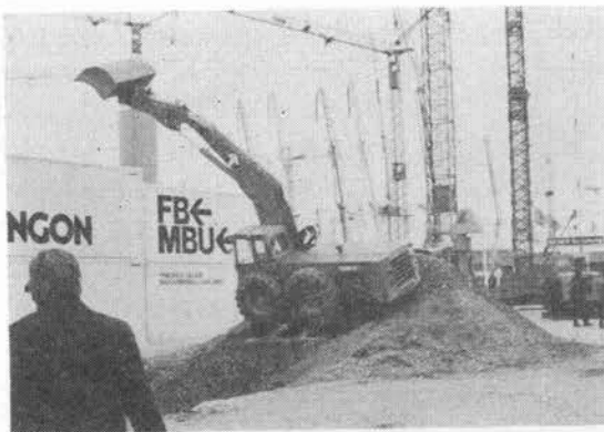
写真-7 走行タイヤをあげて車体の下のアウトリガで全回転するバックホウショベル
