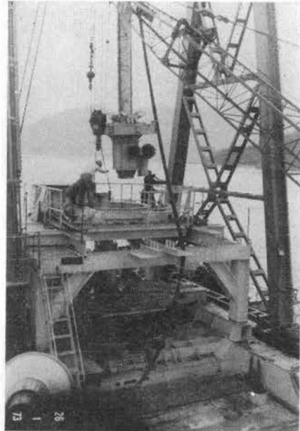
写真-2 掘削作業中の L-10s (石川島播磨重工)
