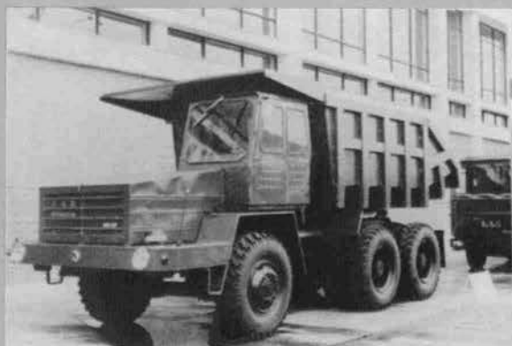
▲専用ダンプトラック 135PS×2基 (ルーマニア) —エスティモ'73—
