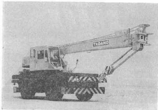
ラフターラインクレーン
