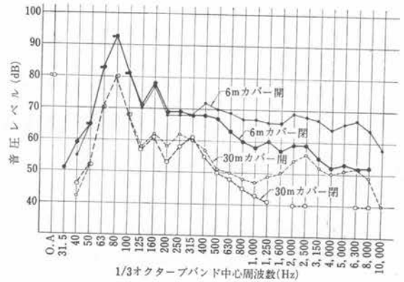
図-292.5 DPV-125 S 形騒音スペクトル (L方向)
