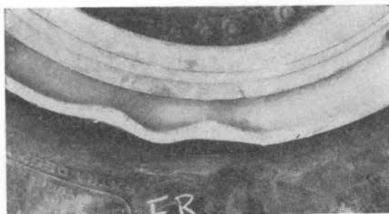
写真-2 リムフランジの異常
