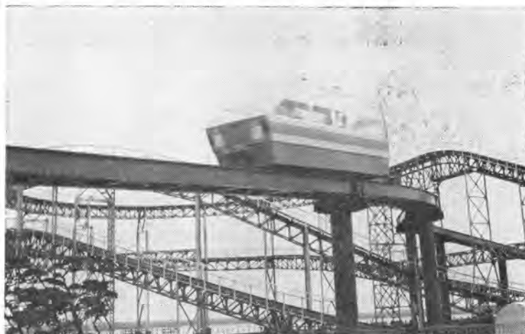
写真-1 谷津遊園内をジェットコースタと交差しながら走行する VONA (1周400m、最小半径20m、最急こう配70%、27人乗り全座席、無人運転)
