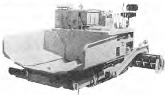
クローラ式アスファルトフィニッシャー HA 36 C
