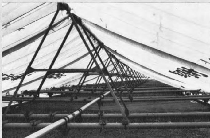
▲機械編隊の最後に延々 120m にわたってつながる三角 屋根テント車の内部で、最後部には毎日の作業開始時 にバックさせるためけん引動力がついている。
