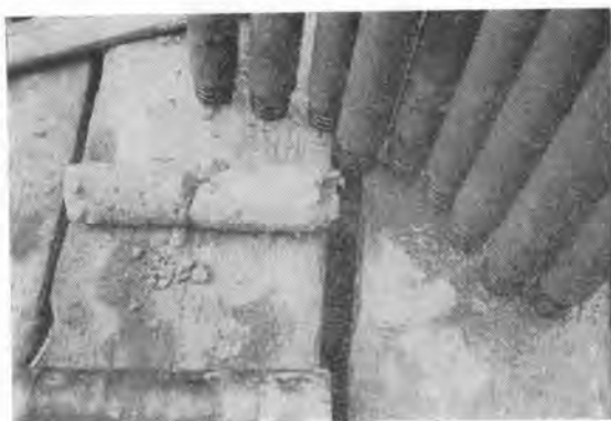
写真-5 採取したコア（左はコンクリート、右は頁岩）
