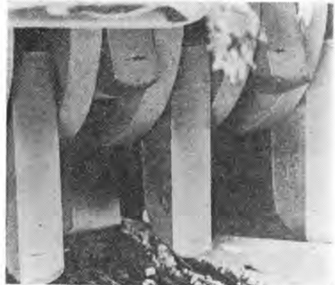
写真-1 偏心軸を中心に回転するハンマをもつ粉碎機
