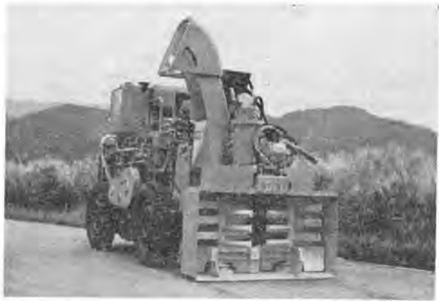
写真-3 立軸小形ロータリ除雪実験車
