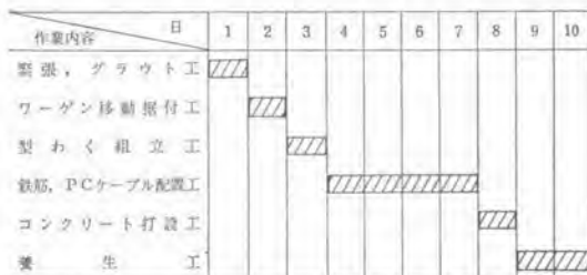
図-5 工程 (1サイクル)
