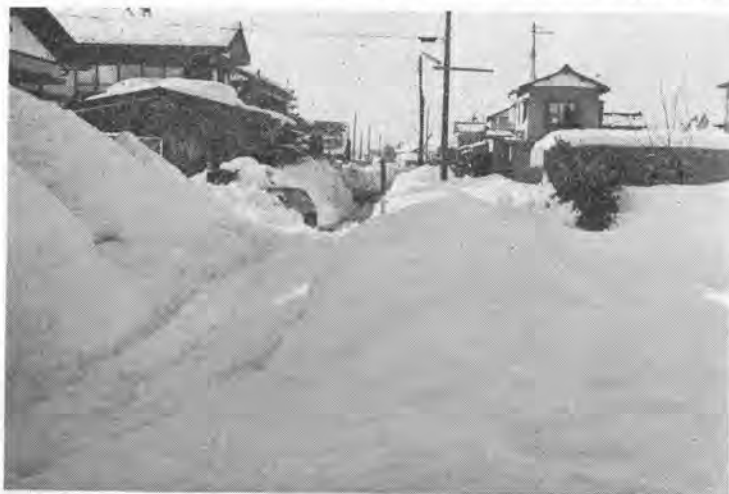
写真-1 屋根雪と機械除雪による狭い街路の側部堆雪状態
