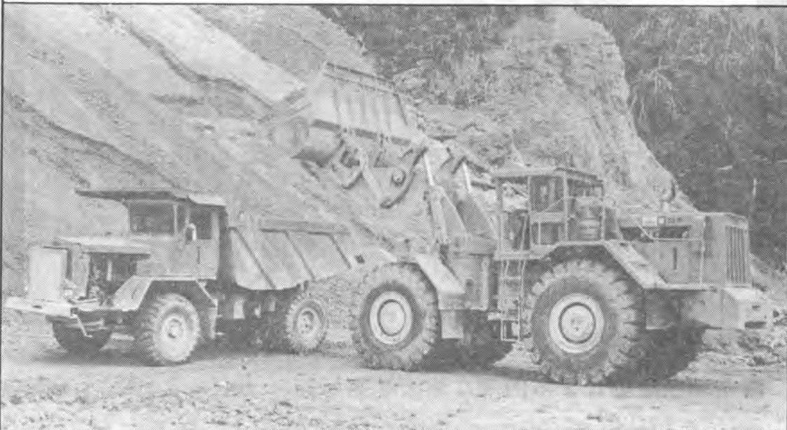
TEREX R-35 リヤ・ダンプ 積載重量 32Ton
