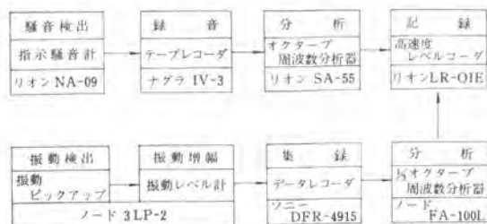
図一 騒音および振動測定器とその構成
