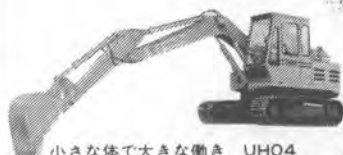
小さな体で大きな働き UHO4 バケット容量…0.4m 3 最大掘削深さ…4.35m 定格出力……81PS 全装備重量……10.5t
