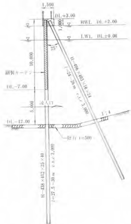
図-6 カーテンウォール標準断面図
