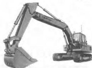
大土量・重掘削の作業に UHO9 バケット容量…0.9m 3 最大掘削深さ…6.52m 定格出力……125PS 全装備重量……20.8t
