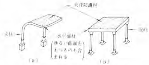
図-3 坑内ずり積み機用ヘッドガードの例
