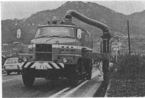
写真-5 側溝清掃車
