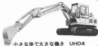
小さな体で大きな働き UH04 バケット容量…0.4m 3 /最大掘削深さ…4.35m 定格出力…81PS/全装備重量…10.5t
