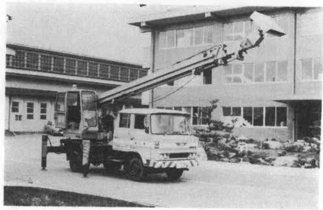
写真-4 のり面点検車
