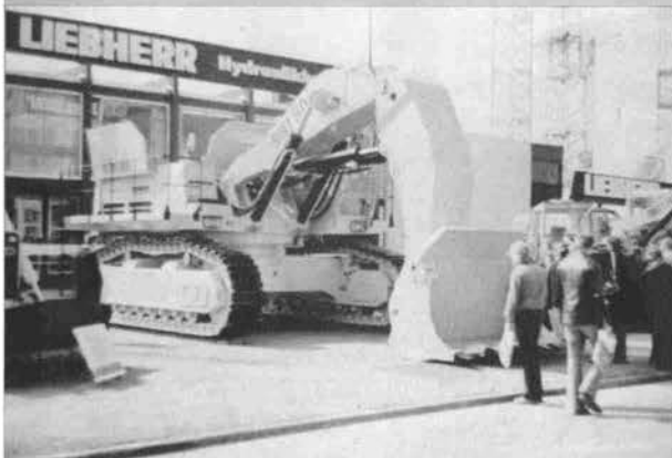
▲ Liebherr 981 HD ローディングショベル (2.2~3.2 m 3 ) *ハノーバーメッセ*
