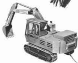
無排気・低騒音のクリーンショベル UH04E(電動式) バケット容量…0.4m 3 /電動機出力…37kW/全装備重量…10.5t
