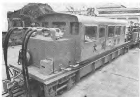
写真-28 トンネル工事用グラウトプラント（先頭車はコントロールユニット）
