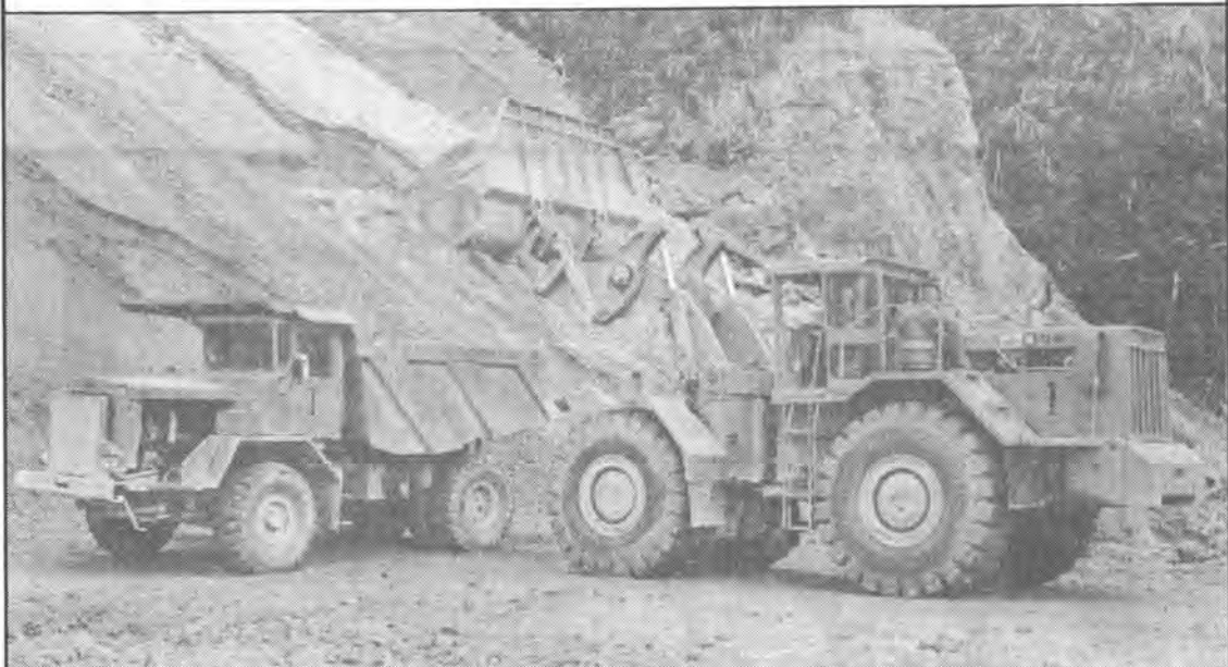
TEREX 72-81 ローダー バケット容量 7m 3
