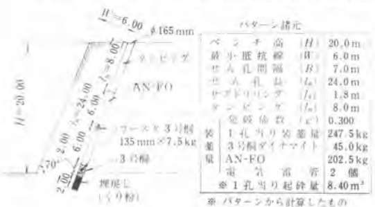
図-2 20mベンチの発破パターン
