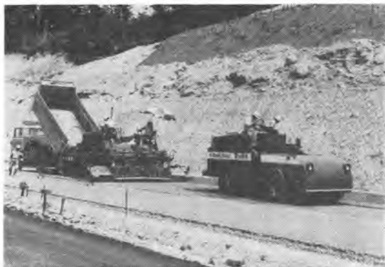
写真-33 川崎 KVR 15 タイヤ・振動ローラ
