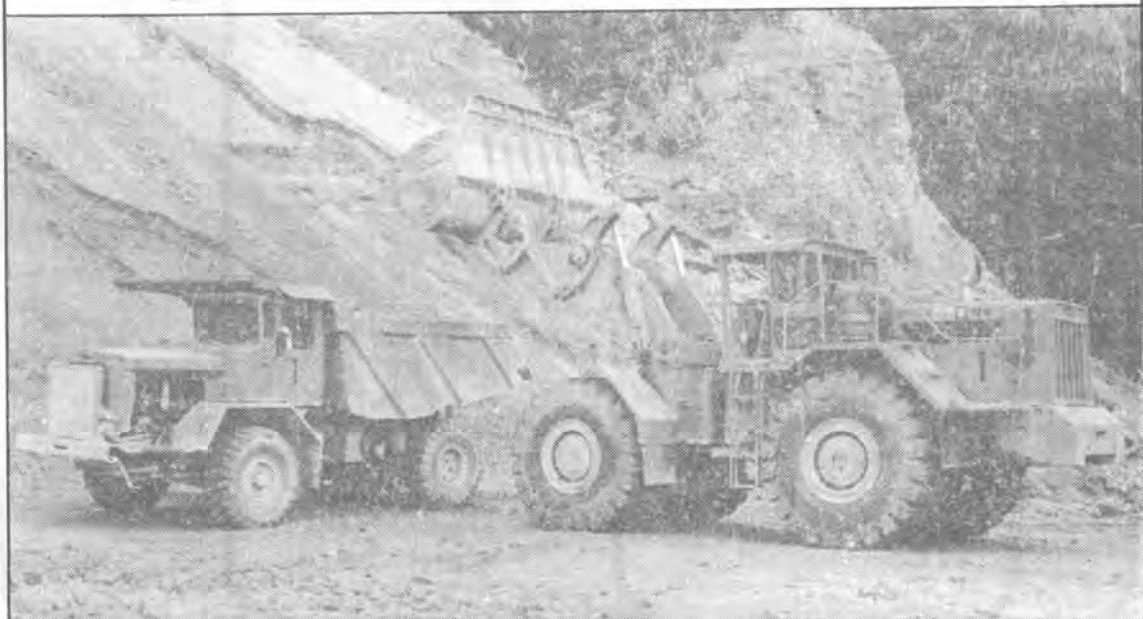
TEREX 72-81 ローダー バケット容量 7m 3
