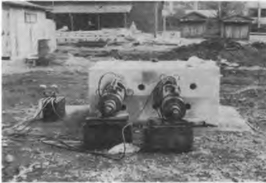
写真-1 供試体破壊（ジャッキ側）
