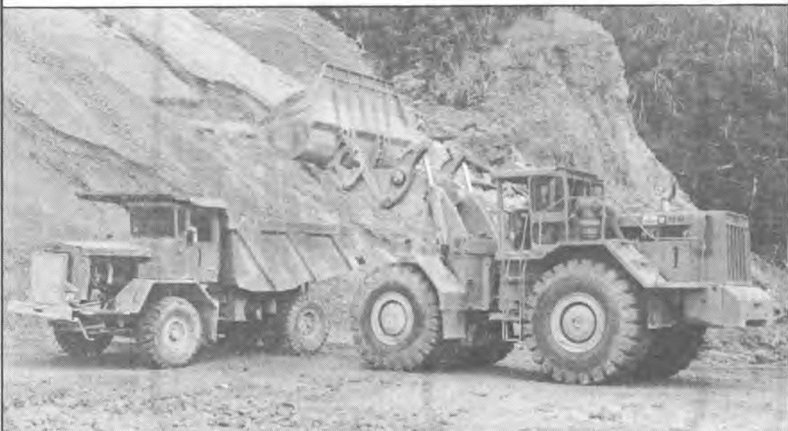
TEREX 72-81 ローダー バケット容量 7m 3
