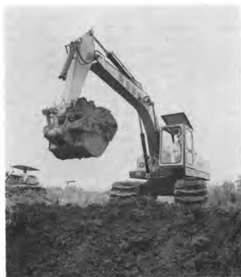
写真-1 湿地用油圧式ショベル “MS 60 L”
