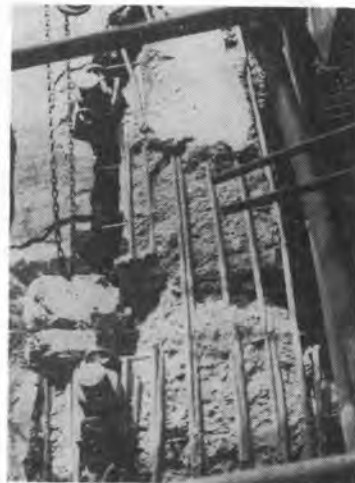
写真-7 現場破壊試験 [II]
