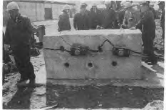
写真-2 供試体破壊（チゼル側）
