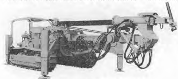
写真-3 吹付用ロボット(吹付ブームが下げた状態)
