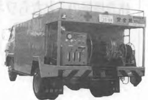
ジェットフラッシャー (高圧下水管洗浄車)
