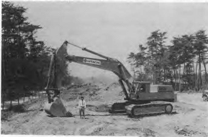
写真-2 2.0 m 3 油圧バックホウ
