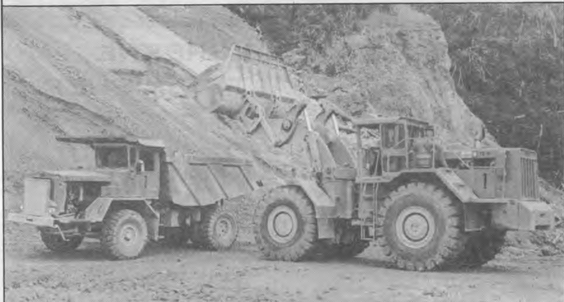
TEREX 72-81 ローダー バケット容量 7m 3
