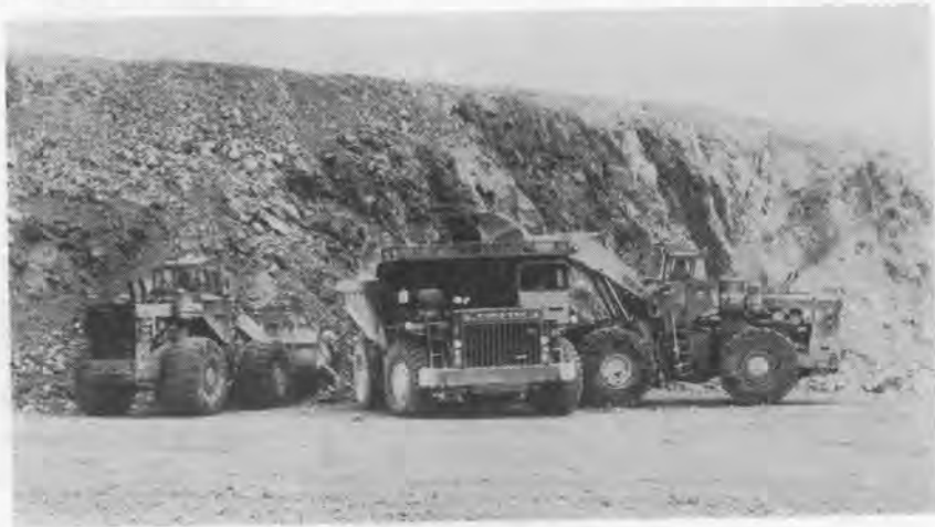
写真-4 68t 積 ダンプトラック
