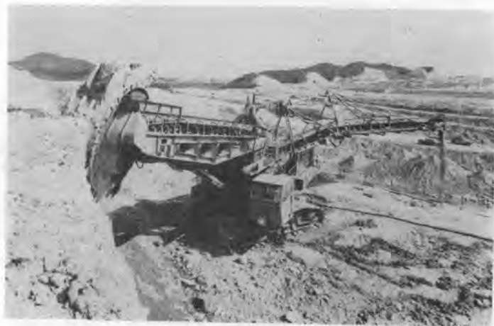
写真-5 2,000 m 3 /hr バケットホイールエキスカベータ
