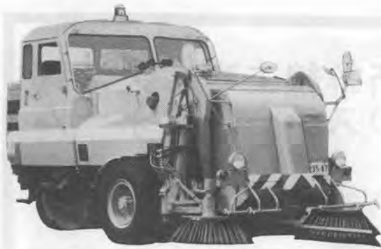
スィーパーローダー (道路清掃用フロントリフトダンプ)
