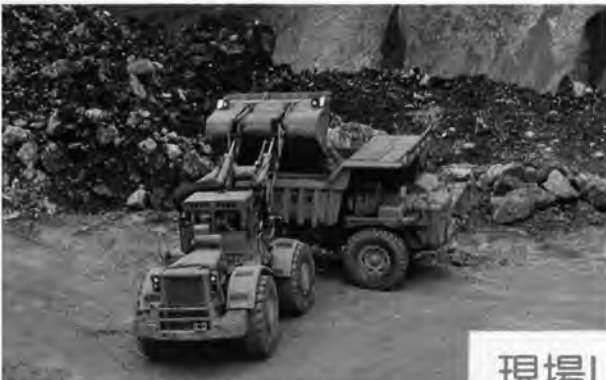
▲ ダンプに積み込み中の 988ホイールローダ
