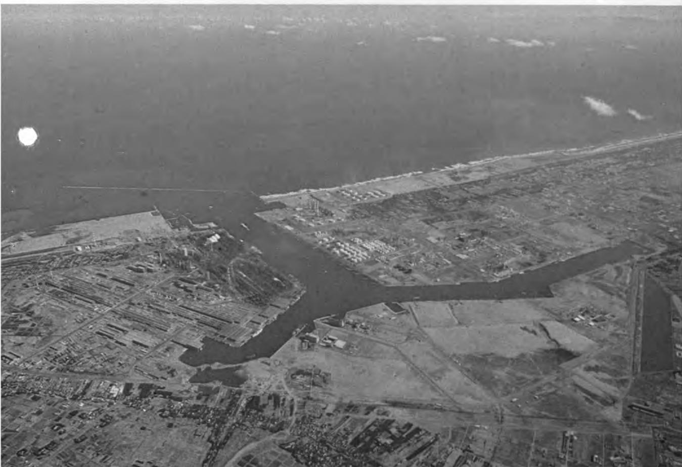
形式 掘込港湾 計画水深 24m(港口) 掘削総土量 1億1,600万m 3 —茨城県— 鹿島港
