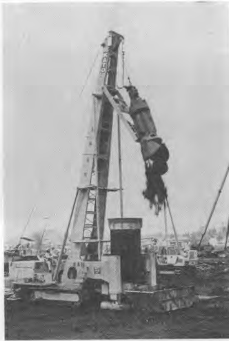
写真-2 ワンエンジン全油圧駆動で組立容易になった KATO 全ケーシング工法専用機 30 THC
