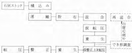
図-5 施工フローチャート
