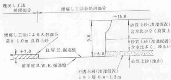
図-6 土取り施工断面 (埋戻し工法)
