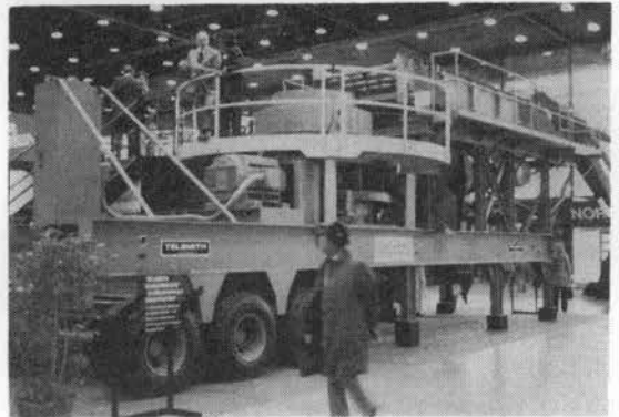
クラッシングプラントのセカンダリーユニット (TelSmith)
