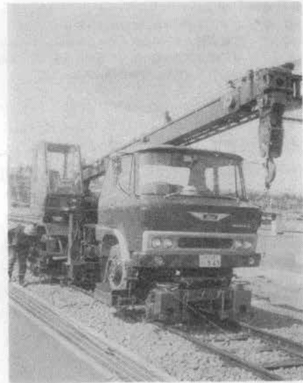
写真-3 トラッククレーン用軌道走行台車
