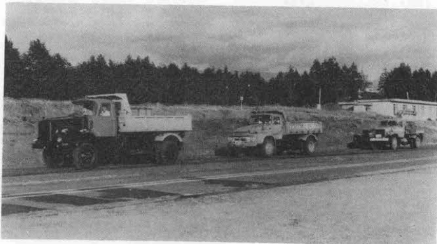
写真—321.1 連続けん引試験状況
