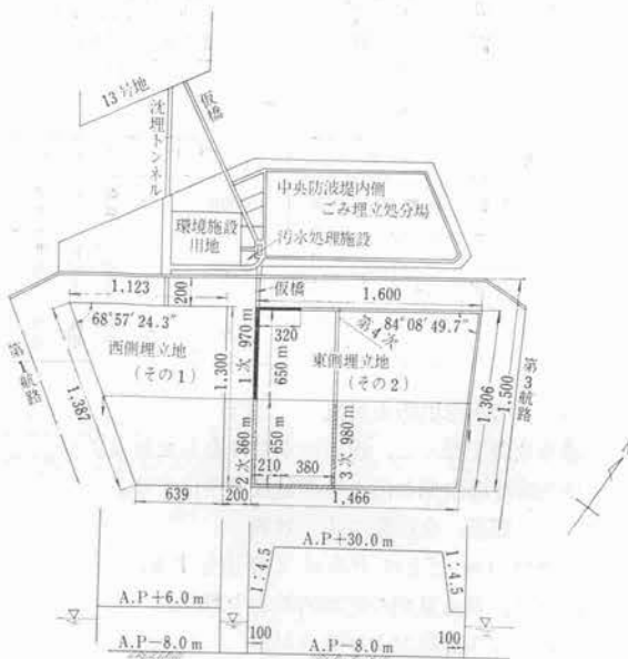
図-4 中央防波堤外側処理場計画平面図 (西側埋立地・東側埋立地)
