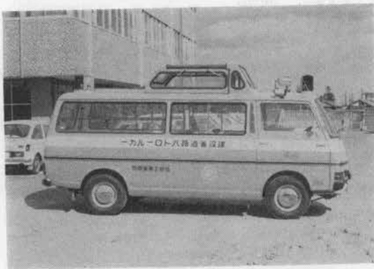
写真-7 パトロールカー (のり面監視装置付)
