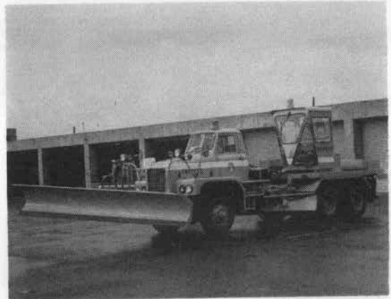
写真-2 10 t 級除雪トラック (改良型)
