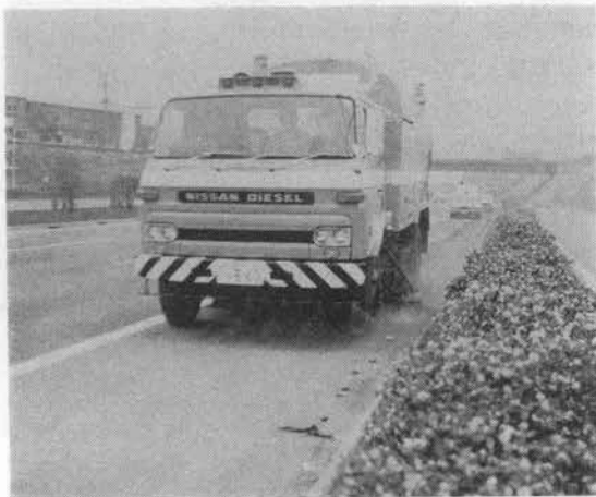
写真-1 高速道路で作業中の高速スイーパー
