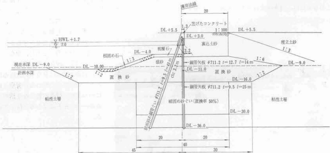
図-6 C 護岸標準断面図
