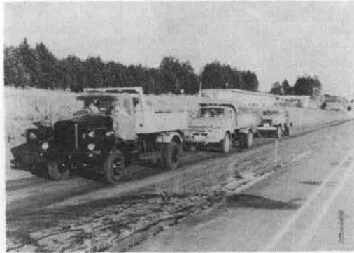
写真—326.1 連続けん引試験状況
