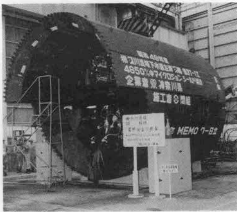
写真-8 メムコ-日立 “マイクロジョン” (掘削機バケット容量 0.05 m³)
