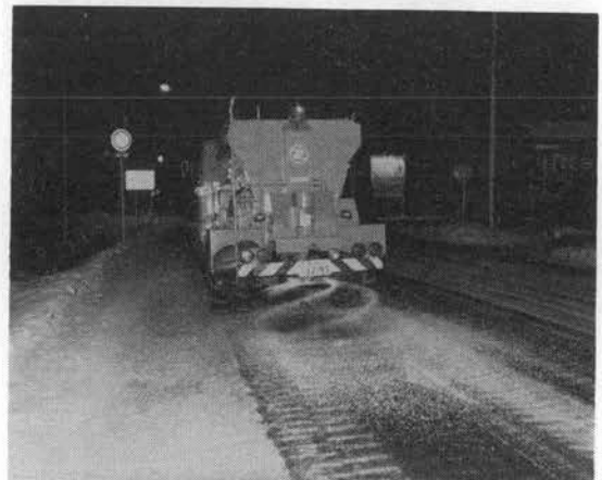
写真-2 薬剤散布中の散布車
