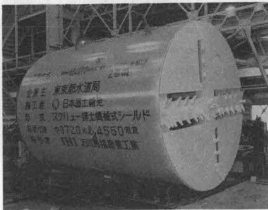
写真-1 前方より見たスクリー-排土機械式シールド
