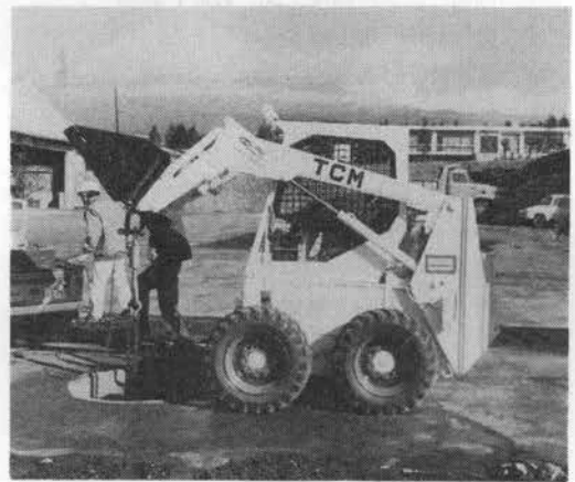
写真—328.1 転倒荷重試験
