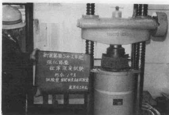
写真-5 現場から採取した凝固鉍滓試料の圧縮試験
