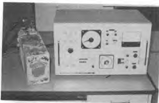
↑ 写真-4 コンクリート初期強度試験機（左は型わく下部に設置の検出部、右は司令室内に設置の操作部）
