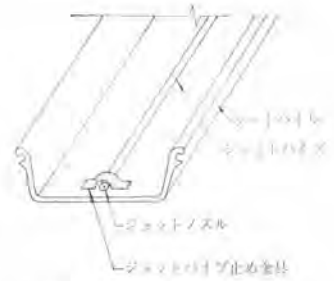
図-7 ジェットパイプ取付図
