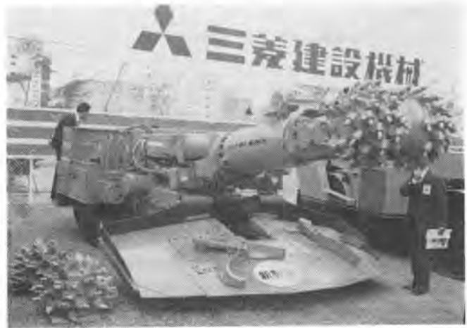
写真-5 ブーム型トンネル掘削機
