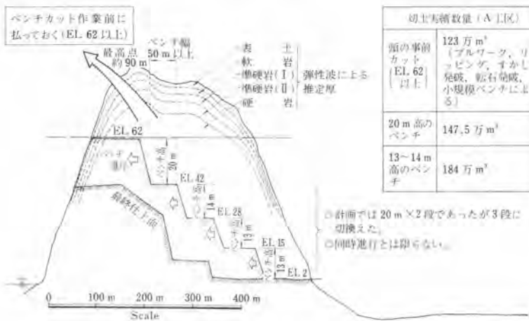
図-4 ベンチカット作業
