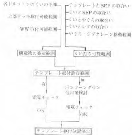
図-4 テンプレート据付検討要領図
