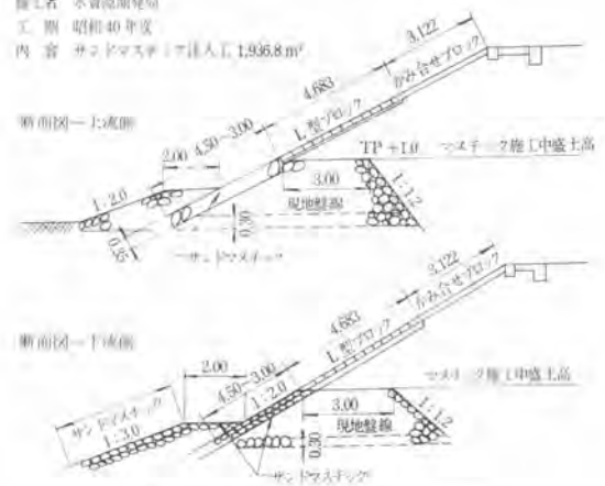
図-7 流し込み工法の施工例（荒川護岸）
